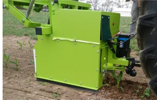
**Figure 3** : à gauche, porteur électrique e-tract d'Elatec ; à droite, bloc-outil BipBip composé d'une chambre de vision et d'un outil de désherbage (ici, un doigt mobile).
